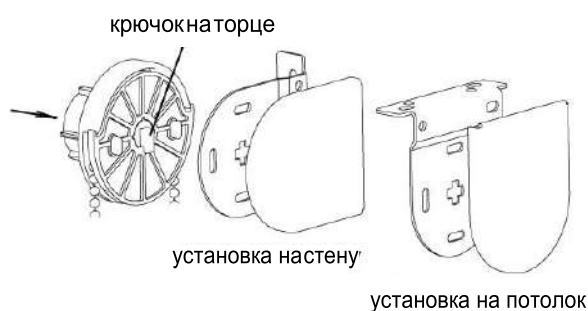
Рис. 4. Установка изделия в кронштейны
